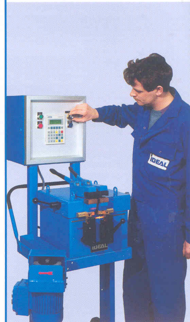
DSH 090 avec système de recuit automatique GSS
