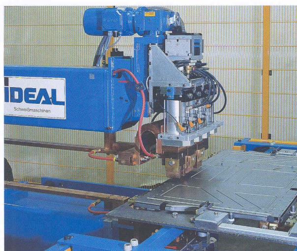
Soudage d'éléments de sièges arrière de voitures
