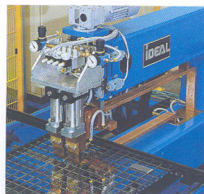
Soudeuse à coordonnées CN type CSR 102
