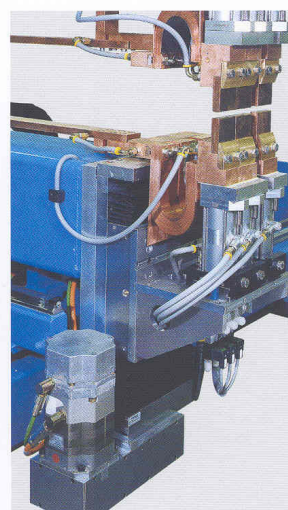
Axe CN inférieure de réglage en hauteur des électrodes
