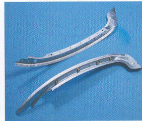
Version spéciale des outils de soudage pour réaliser des rails hybrides pour des portes de voitures
