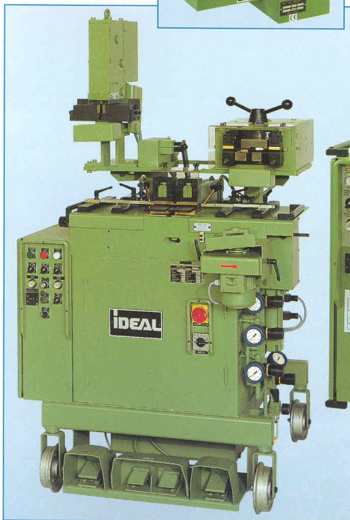
Type BAS 052 avec cisaille pneumatique à double coupe, dispositif de centrage, rabot-ébarvureur et moteur à meuler les rives de feuillard
