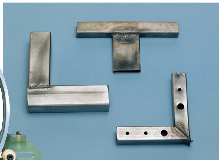
Cadres tubulaires: soudage bout-à-bout, à l'onglet et en T de tubes d'acier
