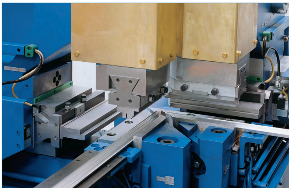
Soudage à l'onglet des cadres de façades en aluminium
