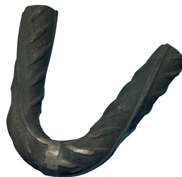
Acier à béton soudé avec acier inoxydable
